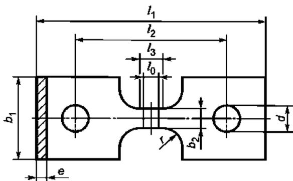
Рисунок 1 — Образец типа 3
